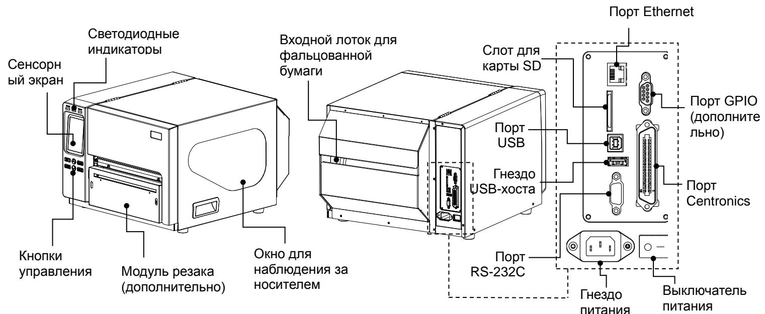
**Примечание** Порты показаны только для иллюстрации. Установленные на устройстве разъемы интерфейса см. в описании технических характеристик данного устройства.
