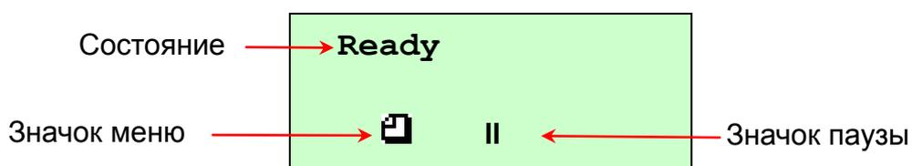
**Примечание.** Если принтер находится в состоянии готовности, при нажатии на значок || отображается индикатор заряда аккумулятора (нажмите эту клавишу еще раз, чтобы вернуться в состояние готовности).
